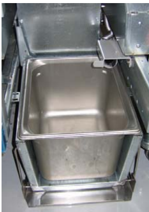
Figura 3: Inserte la bandeja de reserva de aceite interior en el fundidor.
