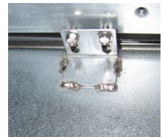
Figura 5: Fije el fundidor a los rieles en ambos lados.
