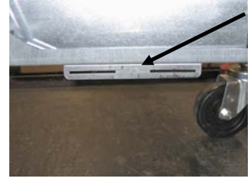
Figura 1: Instale el soporte de alineación en la parte inferior del refuerzo de la caja ATO.
