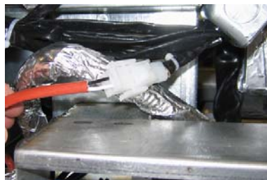
Figura 6: Conecte los conectores blancos de dos clavijas y enchufe el conector negro en el tomacorriente como se muestra. * Tome en cuenta que la posición de la conexión negra puede diferir de la foto.
